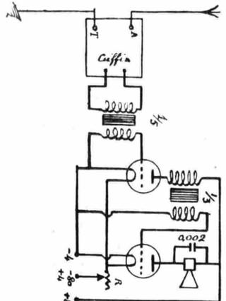
ohm circa. Adotti valvole a consumo ridotto (Micro). Le occorrerà inoltre una batteria anodica da 80 Volt ed una batteria di accensione da 4 Volt. Per quest'ultima posmoniaci collegate in serie.
