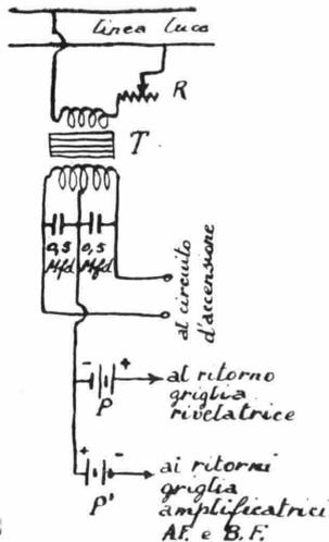
In esso T è un trasformatore abbassatore di potenza adatta al numero di valvole da alimentare, il cui secondario è direttamente collegata al circuito d'accensione dell'apparecchio.
