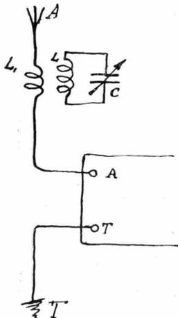
L. accoppiabili in modo variabile, da 50 spire avente in parallelo un condensatore variabile da 0,00005 Mfd. Userà l'apparecchio nel modo normale ed eliminerà le stazioni disturbatrici col condensatore C.
