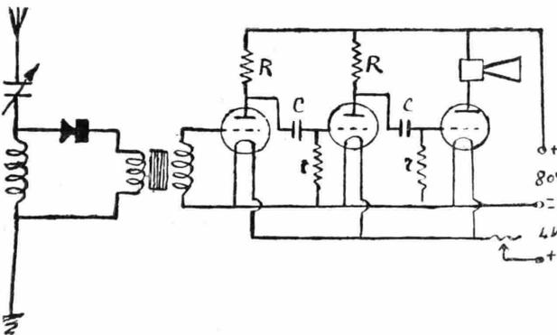
Le resistenze  $R$  sono del valore di 100 a 200 mila ohm; le resistenze  $r$  sono da 4 Hegohm; e i condensatori  $c$  sono da 0,005 Mfd.
