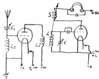
è ora; sopprimere la presa di terra, ed addottare un accoppiatore variabile a tre induttanze anziché a due.
