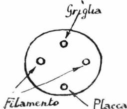
varie lunghezze d'onda. Nel suo caso può usare al posto della bobina L una multidyne ed al posto della L1 mantenere quella a nido d'api. Il suo schema è esatto come collegamento; sono invece errati gli attacchi alle valvole. Tenga presente che in una valvola termionica gli elettrodi sono distribuiti come risulta nello schizzo qui riportato; perciò modifichi i suoi collegamenti come d'accordo con lo schema elettrico del circuito.
