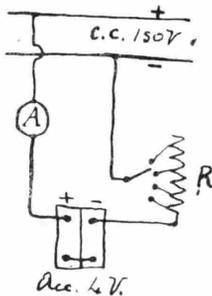
A è un amperometro da 10 amp. in fondo scala; R è un reostato con 10 tasti dalle seguenti caratteristiche:
