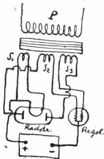
sti S1, deve dare la tensione necessaria all'accensione del filamento della valvola raddrizzatrice; gli altri due danno circa 8 volt ciascuno e sono collegati da un lato alla valvola regolatrice e dall'altro agli anodi della valvola raddrizzatrice.
