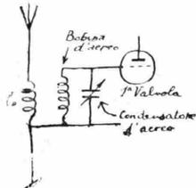
colare alla linea disturbatrice. Inoltre occorre adottare un accoppiamento in Tesla con l'aereo, nel modo indicato nello schizzo qui riprodotto.
