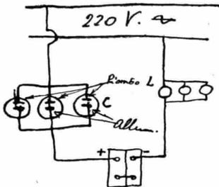
Usi tre celle elettrolitiche in parallelo ciascuna delle quali è costituita da uno dei suoi vasi da pile riempito di una soluzione al 20% di borace nella quale sono immersi una lastra di piombo ed una di alluminio della superficie di poco meno di 1 decimo quadrato.
