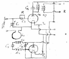
Le bobine L1-L2-L3 sono affacciate a circa 5 mm. di distanza; lo stesso per le bobine L4-L5.
