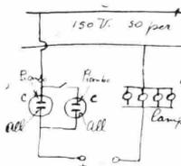
C sono celle elettrolitiche costituite ciascuna da un recipiente della capacità minima di due o tre litri contenente una solu-
