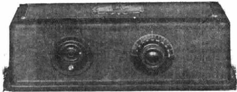
Cassetta completamente in alluminio - Una sola manopola di comando - Un solo reostato
