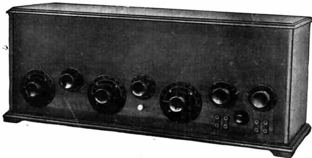
APPARECCHIO tipo R 14 per aereo con due stadi equilibrati di amplificazione in alta frequenza per la ricezione delle radio diffusions europee da metri 200\_a 2000 in altoparlant'e anche durante il funzionamento di stazioni locali.
