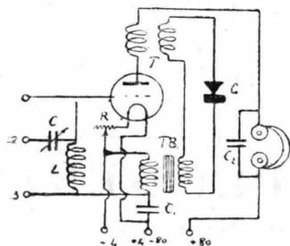
due distinte funzioni: amplificatrice delle vibrazioni sonore a bassa frequenza, rivelate dal detector a galena G.
