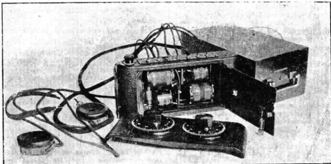
Esso è costituito da due valvole montate in Reflex. Le due valvole sono collocate al posto prima occupato dai due rotoli di
