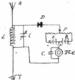
detector a galena il vantaggio di una maggior stabilità di funzionamento non dovendosi con esso cercare dei punti sensibili. Non è affatto vero però che la sua sensibilità pareggi quella di un triodo, anzi come sensibilità, è inferiore ad una buona galena. Il
