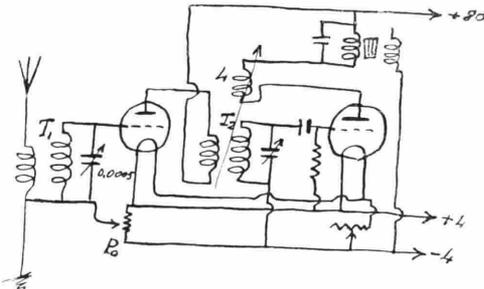
Il trasformatore T1 sarà disposto verticalmente; T2 orizzontalmente e la bobina di reazione L accettabile più o meno strettamente ad una estremità del tubo.
