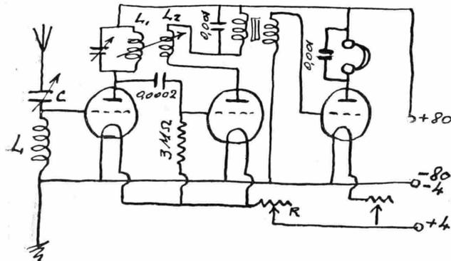
durante la prima prova, il senso giusto dei collegamenti della bobina L2.
