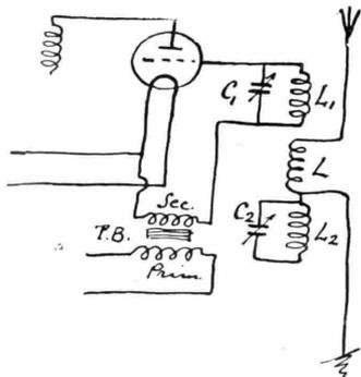
Le bobine L<sub>1</sub> ed L<sub>2</sub> sono a nido d'api ed affacciate ad una distanza di 10 mm. L<sub>1</sub> da L<sub>1</sub> e quasi a contatto L<sub>2</sub> con L<sub>2</sub>.
