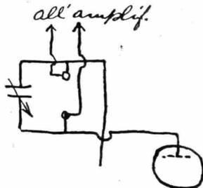
Può migliorarlo facendolo precedere dall'amplificatore ad A. F. illustrato sul N. 50 1926 «Radiorario»; in tal caso disporrà il condensatore d'aereo in parallelo con la bobina 1 (75 spire) come da schizzo qui riprodotto. Collegerà i morsetti 1 e 2 dell'amplificatore al posto della bobina 1 estratta.
