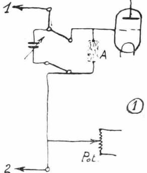
dell'apparecchio come in fig. 1 (schizzo qui riprodotto) (posizione di parallelo e bobina A estratta). I morsetti d'aereo e terra andranno a collegarsi ai morsetti 1 e 2 dell'amplificatore ad A. F.
