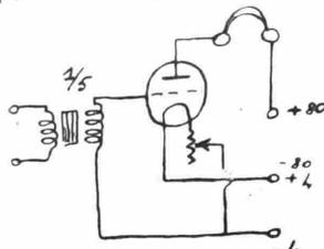
2. Aggiungo una valvola a B. F. secondo il circuito qui riprodotto. Inserirà il primario del trasformatore B. F. 1/ sull'apparecchio al posto della cuffia.
