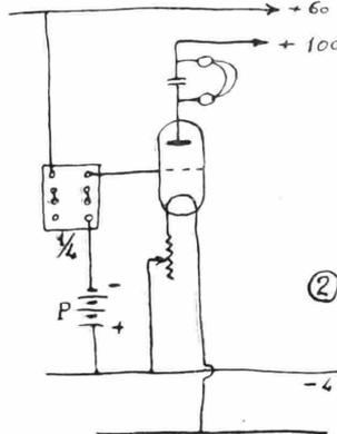
4. Le valvole da lei usate vanno bene eccettuata la RE 114 che sarà bene sostituirle con una RE 064; inoltre sarà bene dare all'ultima valvola una tensione di placca superiore alle altre due (vedi schizzo fig. 2) e inserire fra trasformatore B. F. e circuito d'accensione una pila a secco tascabile da 4,5 Volt.
