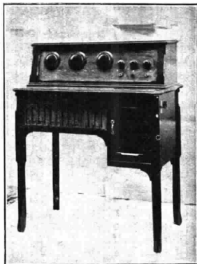
Neutrodina RC montata su mobile con altoparlante e batterie
