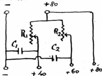
condensatore da 0,002 ed il secondario con una resistenza da 100.000 ohm.
