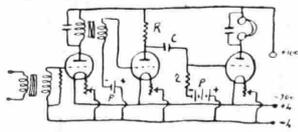
P è una pila da 1,5 Volt (a secco); PI è una pila da 4,5 volt (tascabile).
