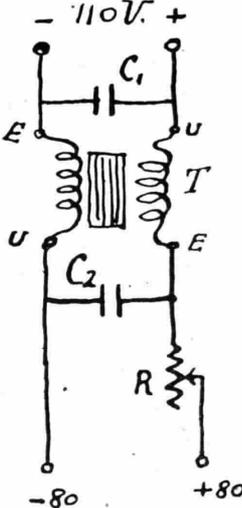
rente della dinamo per l'alimentazione anodica. Interporrà fra dinamo ed apparecchio il filtro indicato nello schizzo qui riprodotto. C1 e C2 sono due condensatori da 2 Mfd. T è un comune trasformatore B. F. rapporto 1/1.
