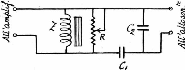
proteggere gli avvolgimenti dell'altosonante dai dannosi effetti di correnti anodiche sovente eccessive e di regolarne il volume di suono progressivamente dallo zero al massimo senza provocare distorsioni nè comunque agire sugli organi di regolazione del ricevitore.
