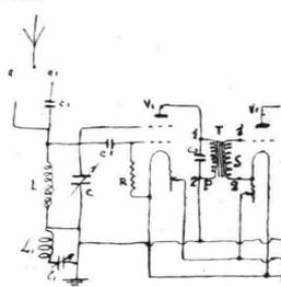
L1 è una bobina a nido d'api da 35 spire, affacciata a circa 5 mm. di distanza alla bobina L; C1 è un condensatore variabile da 0,0005 Mfd.
