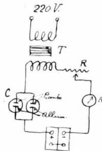
pacità di circa un litro e mezzo, riempite di una soluzione satura di borace e nella quale pesano, distanti 3 cm. circa, due lastre: una di piombo e l'altra di alluminio (dimens. circa 100x150x2 mm.).
