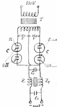
T, è un trasformatore elevatore da 130 a 300 volt (Potenza 50 watt circa) con una presa intermedia sull'avvolgimento 300 volt (secondario).
