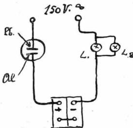
nente una soluzione di borace al 20 per cento (sciolto a caldo) nella quale pescano due lastre; una di piombo ed una di alluminio distanti 30 mm.
