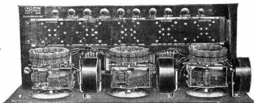
Il "FRESHMAN MULTIPLE,,", comporta un circuito a cinque valvole RCA Radiotrons di cui una di potenza ed una rivelatrice.
