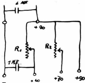
Per ottenere le tensioni intermedie adottati due resistenze variabili R1 e R2 (vedi schizzo) ottimi i tipi americani Clarostat da zero a 500.000 ohm.
