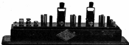
Gli amplificatori UNDA constano di 3 stadi accoppiati a resistenza e capacità e possono essere impiegati in qualsiasi circuito (dettrice con o senza reazione, o amplificatore d'alta frequenza con dettrice) e sono destinati principalmente ad essere montati negli apparecchi. La specie dell'amplificatore ad alta frequenza è indifferente purché esso funzioni inappuntabilmente (neutrodina, supereterodina ecc.)
