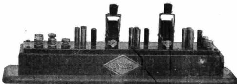
Gli amplificatori UNDA constano di 3 stadi accoppiati a resistenza e capacità e possono essere impiegati in qualsiasi circuito (detertrice con o senza reazione, o amplificatore d'alta frequenza con detertrice) e sono destinati principalmente ad essere montati negli apparecchi. La specie dell'amplificatore ad alta frequenza è indifferente purché esso funzioni inappuntabilmente (neutrodina, supereterodina ecc.)
