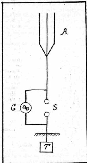
Fig. 42. — Antenna eccitata direttamente.
