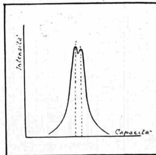
Fig. 44. — Curva di sintonia ad accoppiamento stretto.
