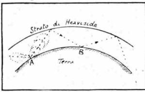
Fig. 45. — Come avverrebbe la propagazione delle onde elettromagnetiche.
