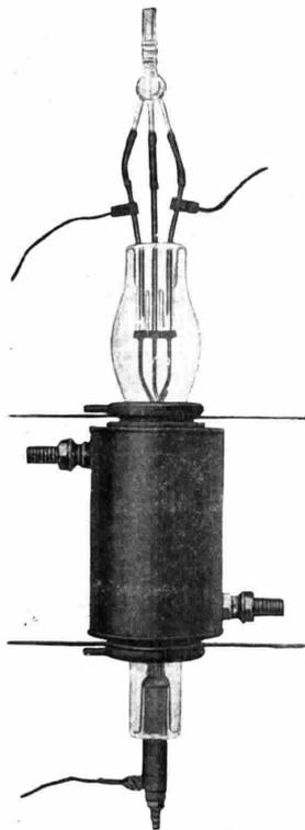
Fig. 62. - Triodo generatore di grande potenza (30 Kw.).
