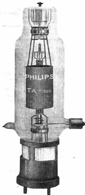
Fig. 61. - Triodo generatore di media potenza (1 Kw.).
