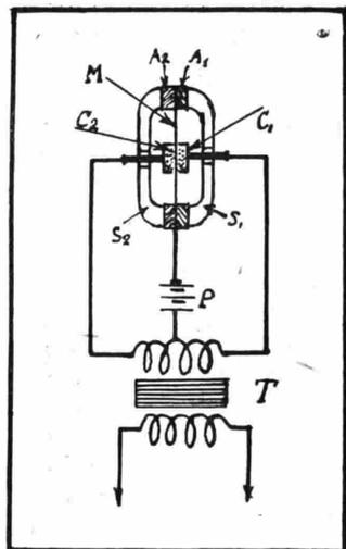
Fig. 70. - Schizzo schematico del microfono Western.
