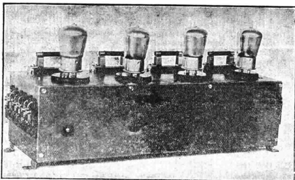
Montato in scatola di rame contiene i 4 scompartimenti, i trasformatori media frequenza e filtro neutralizzati secondo il nostro sistema brevettato « Difarad ».
