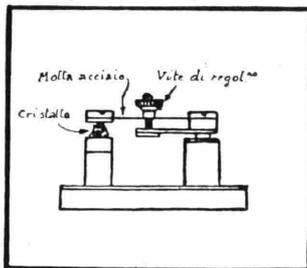
Fig. 91. - Detector a carborundo.
