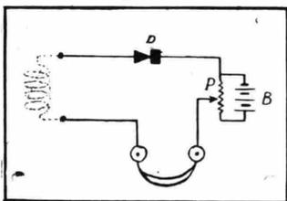
Fig. 90. - Inserzione di un detector carborundo-acciaio.
