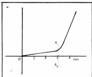
Fig. 89. - Curva caratteristica di un detector carborundo-acciaio.
