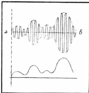
Fig. 87. - Come avviene la rivelazione delle radio-onde modulate.
