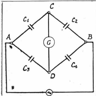
Fig. 112. - Circuito a ponte teorico nel sistema Difarad.
