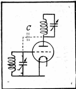
Fig. 106. - Effetto della capacità interna della valvole.
