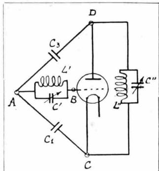
Fig. 113. - Circuito a ponte effettivo nel sistema Difarad.
