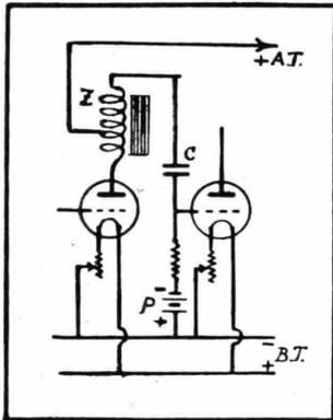
Fig. 118. - Accoppiamento di triodi amplificatori a B. F. col sistema ad autotrasformatori.
