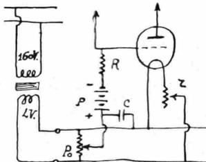
dante un'accurata regolazione di esso è possibile far scomparire ogni ronzio della corrente alternata; la resistenza R da 1 Megohm; il condensatore C da 0,5 Microfarad.
