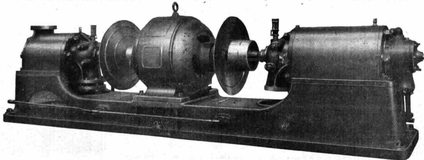
Elettropompa modello Notaresco - Cotonificio Bustese, doppiamente multipla, con 6 + 5 = 11 giranti e Motore da HP. 30. Riceve sotto carico 12 mc ora di acqua **tenidissima** a 13 atmosfere, e la spinge in caldaia contro 29 atmosfere. — Con speciale circolazione di acqua fredda ai cuscinetti della Pompa e sotto il Motore elettrico per impedire l'eccessivo riscaldamento in seguito all'acqua bollente.
