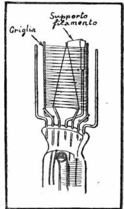
Fig. 128. - Griglia e filamento di un elemento triodico a forma schiacciata (verticale).
