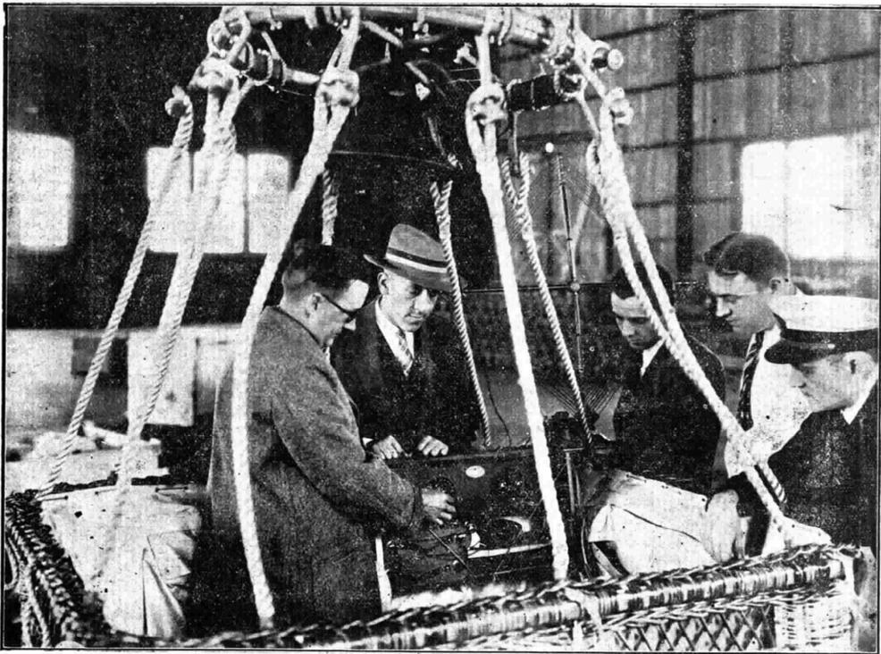
Un radiorecettore montato nella navicella di un pallone aerostatico. — Tale impianto si è dimostrato utilissimo nelle gare sportive di ascensioni in pallone libero, poiché i vari concorrenti possono essere tenuti costantemente informati delle condizioni meteorologiche del tempo o di qualsiasi altra notizia che può interessarli.
