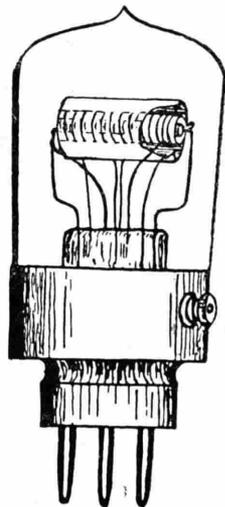
Valvola bigriglia di potenza DV 8 P impiegata nel circuito (2) per un dispositivo trasmittente ricevente duplex per radiotelegrafia. In questo circuito viene impiegato un tetrodo come oscillatore e ricevitore ed un triodo quale modulatore ed amplificatore.
