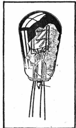
Fig. 129. - Come è collocato internamente all'ampolla, un elemento triodico a forma schiacciata (verticale).
