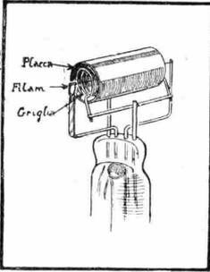
Fig. 126. - Elemento triodico a forma cilindrica.
