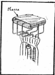
Fig. 127. - Elemento triodico a forma schiacciata (orizzontale).
