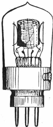
Valvola con catodo alim. mista da corrente alternata "Volta 3" impiegata nel circuito N. 1
