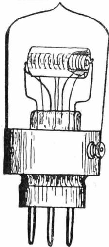
Valvola bigriglia di potenza DV 8 P impiegata nel circuito (2) per un dispositivo trasmittente e ricevente di plex per radiotelegrafia. In questo circuito si è impiegato un tetrodo come oscillatore e ricevitore e un triodo quale modulatore ed amplificatore.
