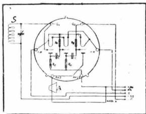
Fig. 137. - Schema circuiti interni della valvola di Loewe.
