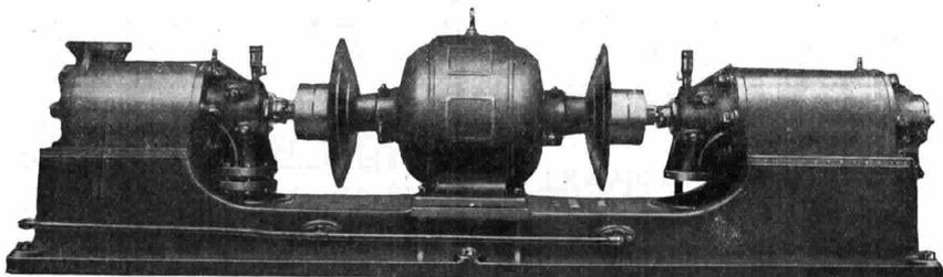
Elettropompa modello Notaresco - Cotonificio Bustese, doppiamente multipla, con 6 + 5 = 11 giranti e Motori da HP. 30. Riceve sotto carico a 12 mc/ora di acqua caldissima a 13 atmosfere, e la spinge in caldaia contro 39 atmosfere - Con speciale circolazione di acqua fredda i cuscinetti della Pompa e sotto il Motore Elettrico per impedire l'eccessivo riscaldamento in seguito all'acqua bollente.
