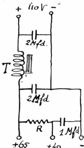
T, è il suo trasformatore Ferris. R, è una resistenza (silite) da 80.000 ohm. Occorrono due condensatori da 2 Mfd. ed uno da 1 Mfd.
