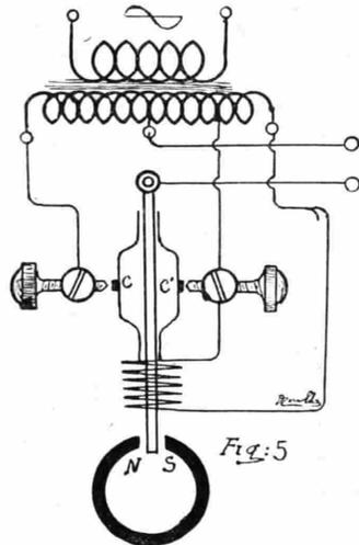
Così la membrana, che nella posizione di riposo è leggermente discosta dal pelo della elettrocalamita, vibra sincronicamente con la corrente, e poiché porta un contatto platinato contro cui sta la relativa vite micrometrica e il tutto è inserito in serie con la batteria e la corrente alternata, è chiaro che nella batteria passerà una corrente pulsante ma diretta sempre nello stesso senso.
