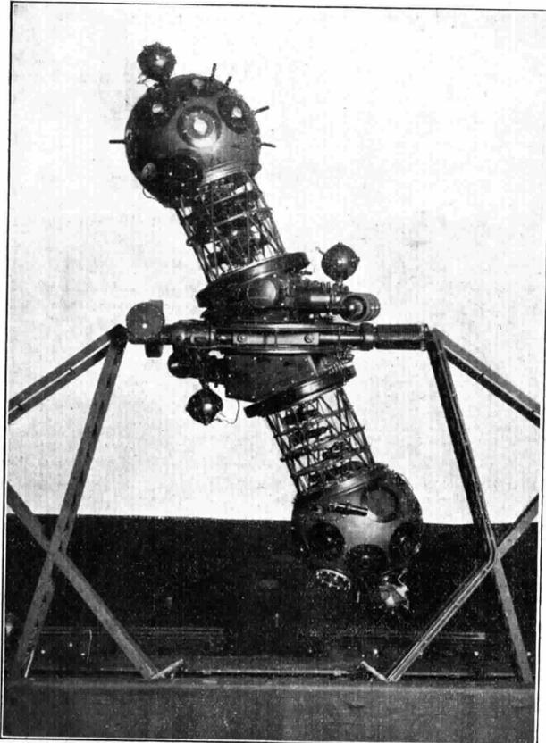
Il Planetario Zeiss è lo strumento meraviglioso che permette di proiettare sulle pareti interne di una cupola speciale una artificiale volta celeste riprodotte con assoluta fedeltà quella naturale.
