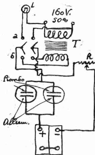
Eccole lo schema dell'installazione completa per la ricarica di entrambe le batterie.
