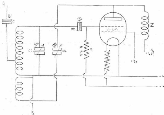
vere esattamente una resistenza propria espressa in ohm. Chiedo appunto quale resistenza deve avere questa impedenza e se si può costruire detta impedenza invece che con del comune filo di rame, con filo di costantana diminuendo così il numero delle spire da aversi.
