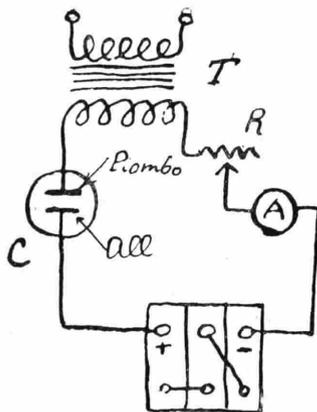
C è una cellula elettrolitica della capacità di 2 litri circa contenente una soluzione al 20% di borace (sciolto a caldo) entro la quale pescano due elettrodi (piombo e alluminio) distanti 20 mm. e delle dimensioni di 10x5 cm. (spessore 2-3 mm.).
