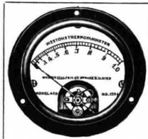
Amperometri da antenna
