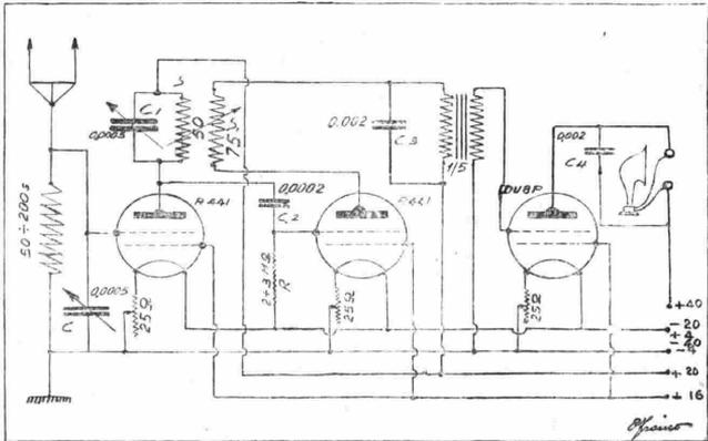
rivelatrice. Abbiamo preferito un tipo di condensatore da mezzo millesimo appunto per la maggiore capacità interna, caratteristica delle lampade a doppia griglia.
