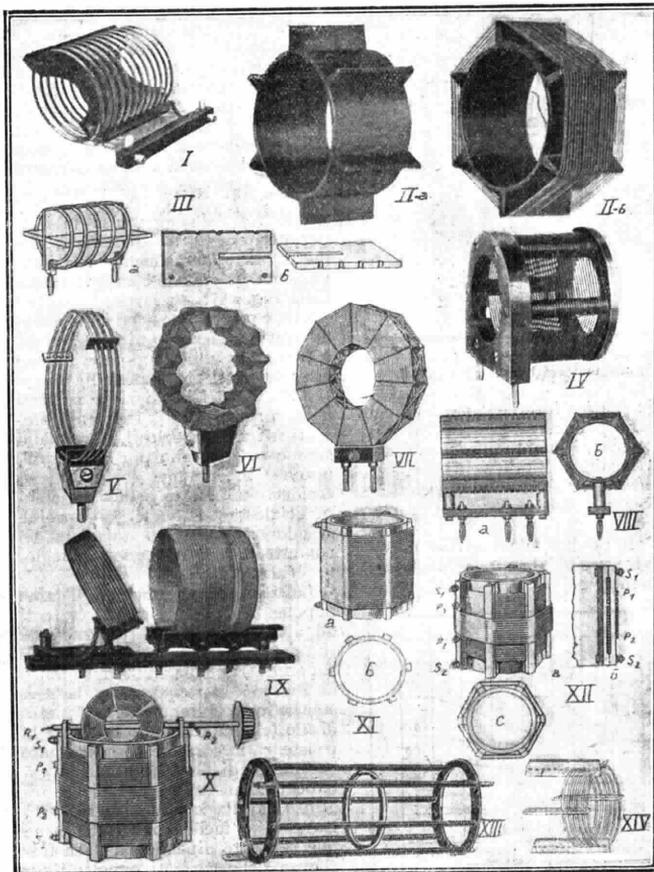
Fig. 161. Alcuni tipi di induttore a minima perdita
