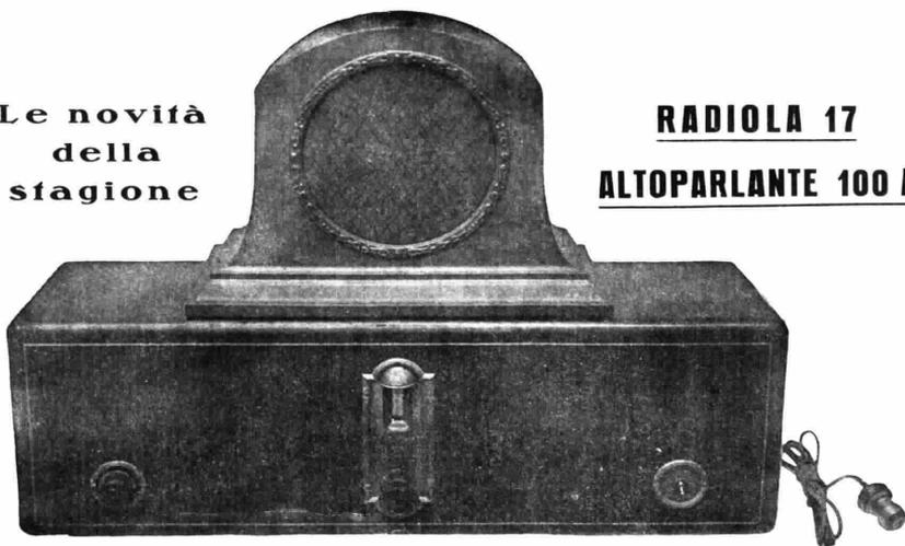
Apparecchio ricevente a 6 Radiotrons a comando unico alimentate direttamente dalla corrente alternata. Non occorrono più né accumulatori né batterie anodiche. — Tre stadi di alta frequenza, una deteccrice, e due stadi di bassa frequenza.
