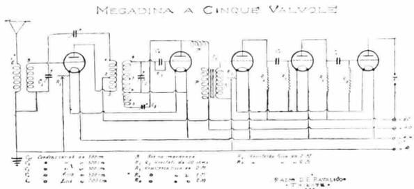
Nello schema si osservano due condensatori variabili che corrispondono alle tre manopole demoltiplicatrici dell'apparecchio. Due soli servono però alla ricerca delle stazioni, il terzo solo per regolare la potenza dell'apparecchio.
