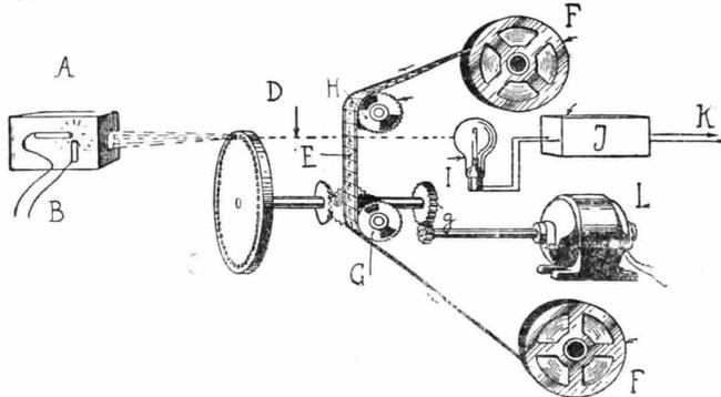
Figura 1 - Schema di principio del trasmettitore telecinematografico:
