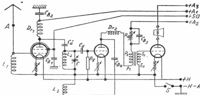
Il gruppo d'accordo-reazione L<sub>2</sub>-L<sub>3</sub> è intercambiabile a seconda del campo d'onde richiesto e cioè:
