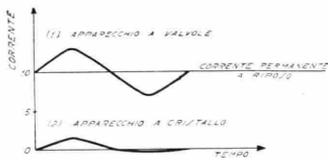
Fig. 3 - CURVE DI CORRENTE NEL RICEVITORE TELEFONICO COLLEGATO COME IN (1) O IN (2)
