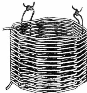
Fig. 167. Bobina a gabbione estratta dallo scheletro
