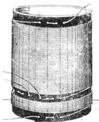
Fig. 102. Bobina cilindrica avvolta su tubo isolante
