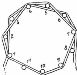
Fig. 165. Sistema d'avvolgimento delle bobine a gabbione
