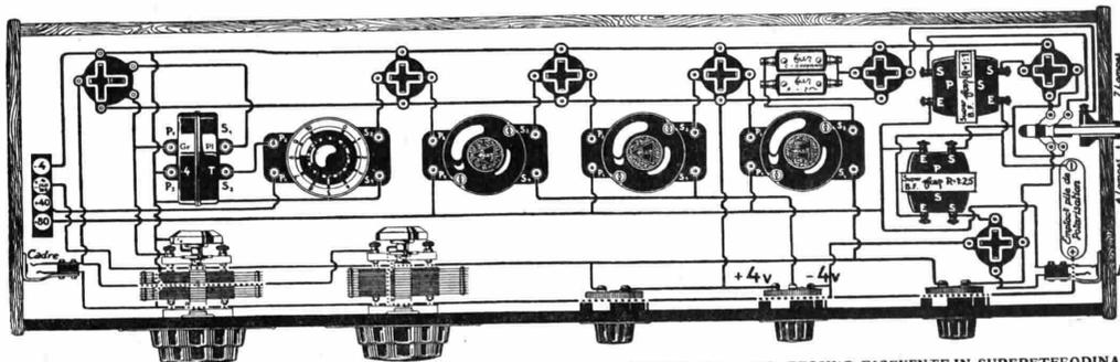
SCHEMA FORNITO IN GRANDEZZA NATURALE CON LA SCATOLA PER LA COSTRUZIONE DI UN A. P. RECCHIO RICEVENTE IN SUPERETERODINAMICA A 7 VALVOLE MONTATO IN BIGRIGLIA PER ONDE DA 250 A 3000 METRI, SCATOLA FORNITA ESCUSIVAMENTE CON MATERIE
