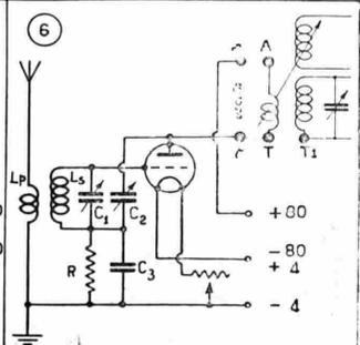
I circuiti monovalvolari indicati negli schemi 1, 2, 3 e 4 sono soggetti ad irradiare forti oscillazioni dall'aereo col quale sono collegati. Una variante che ricorre frequentemente allo schema 1 è costituita dalla soppressione della bobina d'aereo disaccordata; in tal caso l'aereo è collegato direttamente all'estremità superiore della bobina d'accordo (accoppiamento diretto). Tali circuiti possono essere seguiti da una o due valvole amplificatrici a bassa frequenza.
