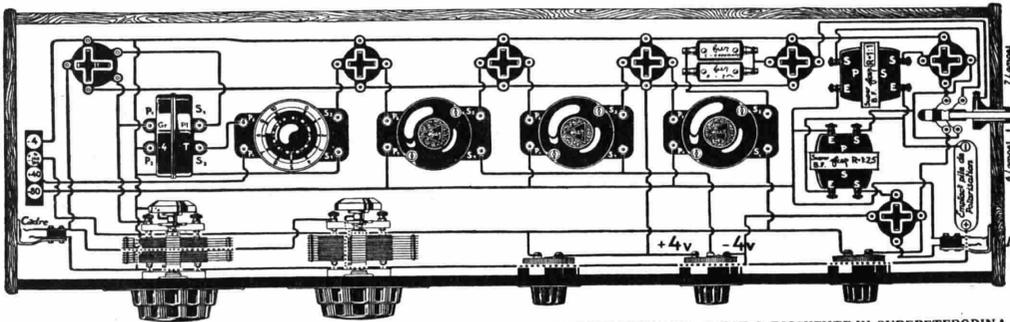
CHEMA FORNITO IN GRANDEZZA NATURALE CON LA SCATOLA PER LA COSTRUZIONE DI UN APP. RECCHIO RICEVENTE IN SUPERETERODINA A 7 VALVOLE MONTATO IN BIGRIALIA PER ONDE DA 250 A 3000 METRI, SCATOLA FORNITA ESCLUSIVAMENTE CON MATERIALI FAR E AL PREZZO MINIMO DI L. 708. FRANCO DESTINO
