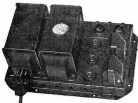
**MIK 1** - Amplificatore microfonico funzionante direttamente in alternata. Messo in connessione con un microfono a carbone con un amplificatore PAM e con un *Magnavox* costituisce quanto necessita per l'impianto di un « *Public Address* ».
