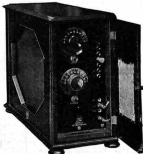
Apparecchio ricevente con diffusore completamente alimentato
