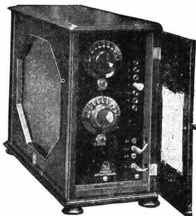
Apparecchio ricevente con diffusore completamente alimentato
