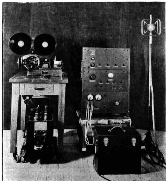
Complesso per la registrazione fonica su film. Sistema «Photophone». Da destra a sinistra: microfono, amplificatori, dispositivo di registrazione ottica.
