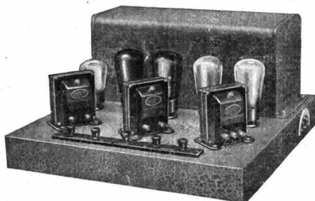
Gli Amplificatori « Brunet », costruiti dagli Etablissements Brunet, di Parigi, sono studiati per funzionare direttamente dalla rete luce a 110 Volte, 42-50 periodi; e servono tanto come amplificatori grammofonici, in unione ad un Pick-Up, quanto come amplificatori radiofonici. Nella loro costruzione sono usati i famosi Trasformatori « Orthoformer ».
