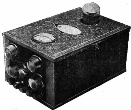
Sostituiscono le BATTERIE utilizzando la corrente alternata della rete di illuminazione
