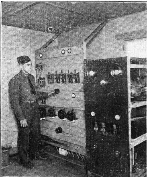
Il tenente Benjamin Kelsey vicino alla trasmettente di un Kw. che lo guidò, nel suo recente volo alla cieca, sano e salvo fino all'atterraggio. La trasmettente funziona premendo un solo bottone.
