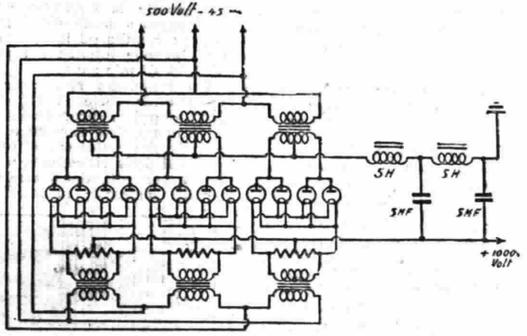
Fig. 9 - Schema di principio raddrizzatore anodico a 10.000 Volt
