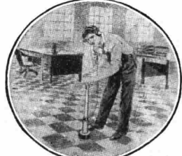
Il nuovo strumento che accetta il punto preciso in cui si trovano i fili elettrici nascosti dei palazzi moderni.
