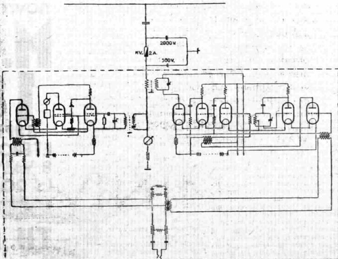
Schema dell'impianto trasmettente e ricevente.
