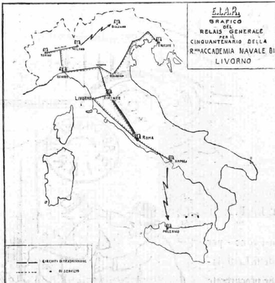
Il grafico soprariportato rappresenta lo schema dei circuiti telefonici che hanno munito le stazioni dell'Eiar durante la trasmissione della commemorazione del 50° anno della R. Accademia Navale ed altresì per la trasmissione da Livorno dell'opera « Le Maschere » di S. E. Mascagni.
